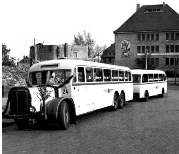
Die Eröffnung der Linie F nach Übigau erfolgte am 1. Mai 1952 mit Anhängerzügen. Der Wagen Nr. 24 ist ein Büssing VI GLn Baujahr 1929, der nach 1945 mit einer offenen Ladefläche versehen wurde und 1950 im VEB LOWA Werdau eine neue Omnibuskarosserie erhielt. Der Anhänger wurde ebenfalls 1950 in Werdau erbaut. Foto: DVB
