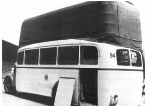
Der Omnibus Nr. 94 (Opel Blitz Baujahr 1938) mit einem Dachaufbau, der die Gummiblase für das Niederdruck-Stadtgas verdeckt. In dem geöffneten Kasten ließen sich für größere Fahrstrecken zwei Flaschen mit Flüssiggas unterbringen.
