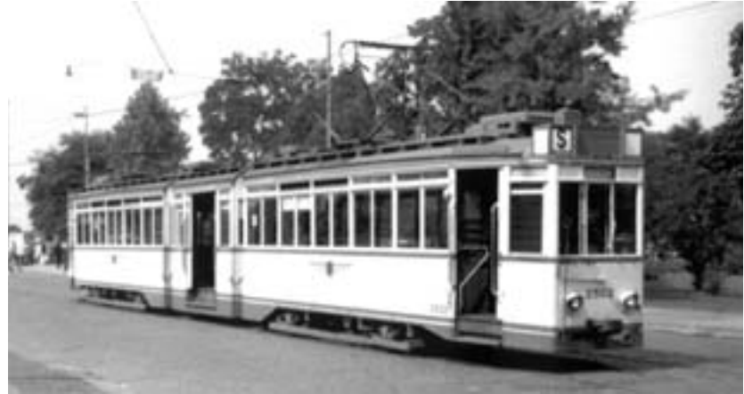
Die Dresdner Straßenbahn erwarb im Jahre 1928 Gelenkstraßenbahnwagen, die von mehreren Waggonfabriken als Neuheit angeboten wurden. Mit ihrer hohen Geschwindigkeit wären diese Fahrzeuge für eine Schnellstraßenbahn geeignet gewesen, doch waren zu ihrer Bedienung bei dem damaligen komplizierten Tarif zwei Schaffner notwendig und der Instandhaltungsaufwand war hoch, so dass eine weitere Beschaffung unterblieb.
